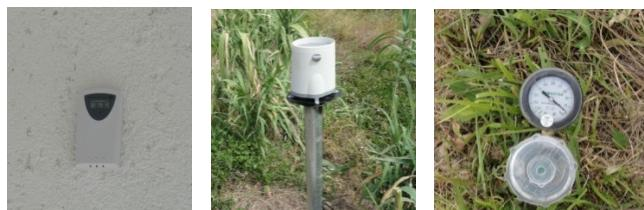
Slika 25. Termohigrometar TFA Nexus (lijevo); kišomjer (ombrograf) TFA Nexus (sredina) i irometar (tenziometar) (desno), okolica jezera Butonige, 9. 08. 2017. (foto: S. Godena).
